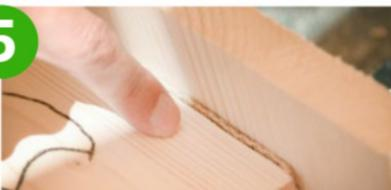
Nach dem Zusammenbau dürfen zwischen Dach und umliegenden Bauteilen keine Spalten bleiben, denn Fledermäuse mögen keinen Durchzug. Für Abhilfe sorgt beispielsweise Sisalband.
