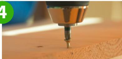
Löcher für die Schrauben laut Anleitung vorbohren, danach die Einzelteile zusammenschrauben.
