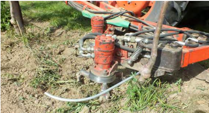
Abb. 8: Krümmler mit hydraulischer Stammauslenkung
