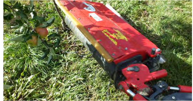
Abb. 9: Fadengerät mit mechanischer Stammauslenkung
