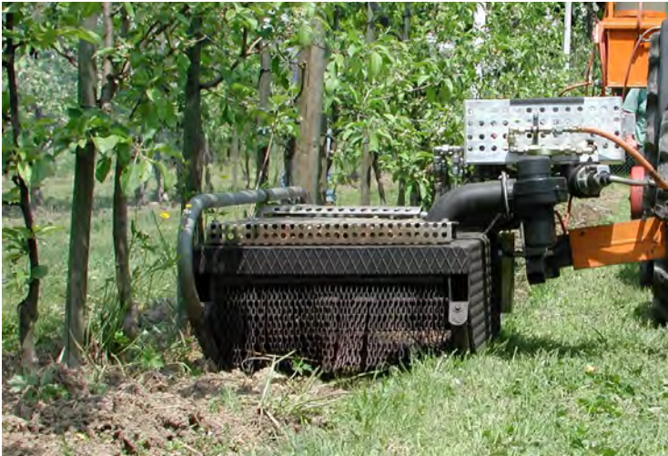
Abb. 27: Behandlung des Baumstreifens mit einem Abflammgerät mit direkter offener Flamme
